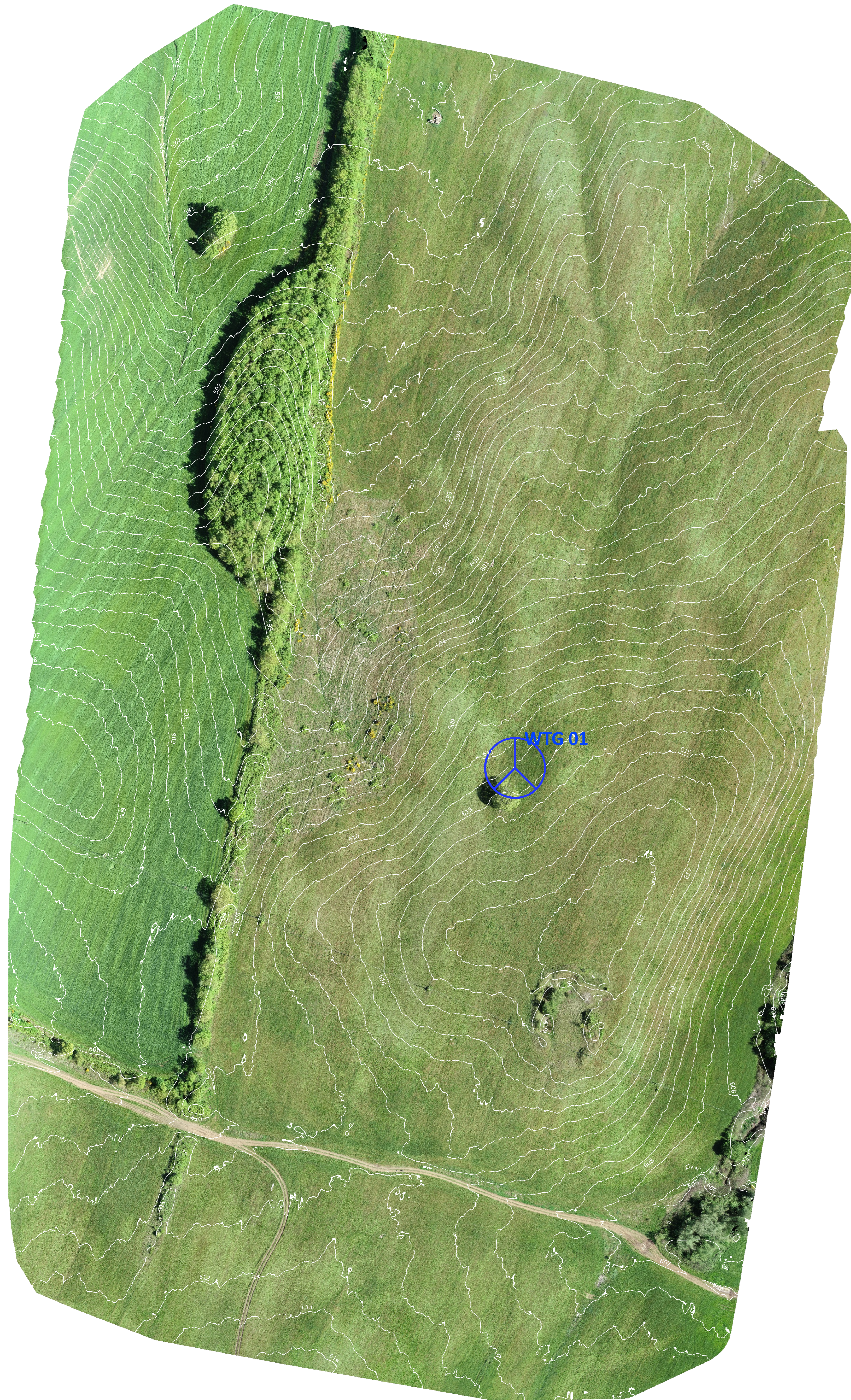
AREA WTG 1 ORTOFOTO DA RILIEVO DRONE CON CURVE DI LIVELLO risoluzione foto 3 cm/pixel - risoluzione DTM 25 cm/pixel
