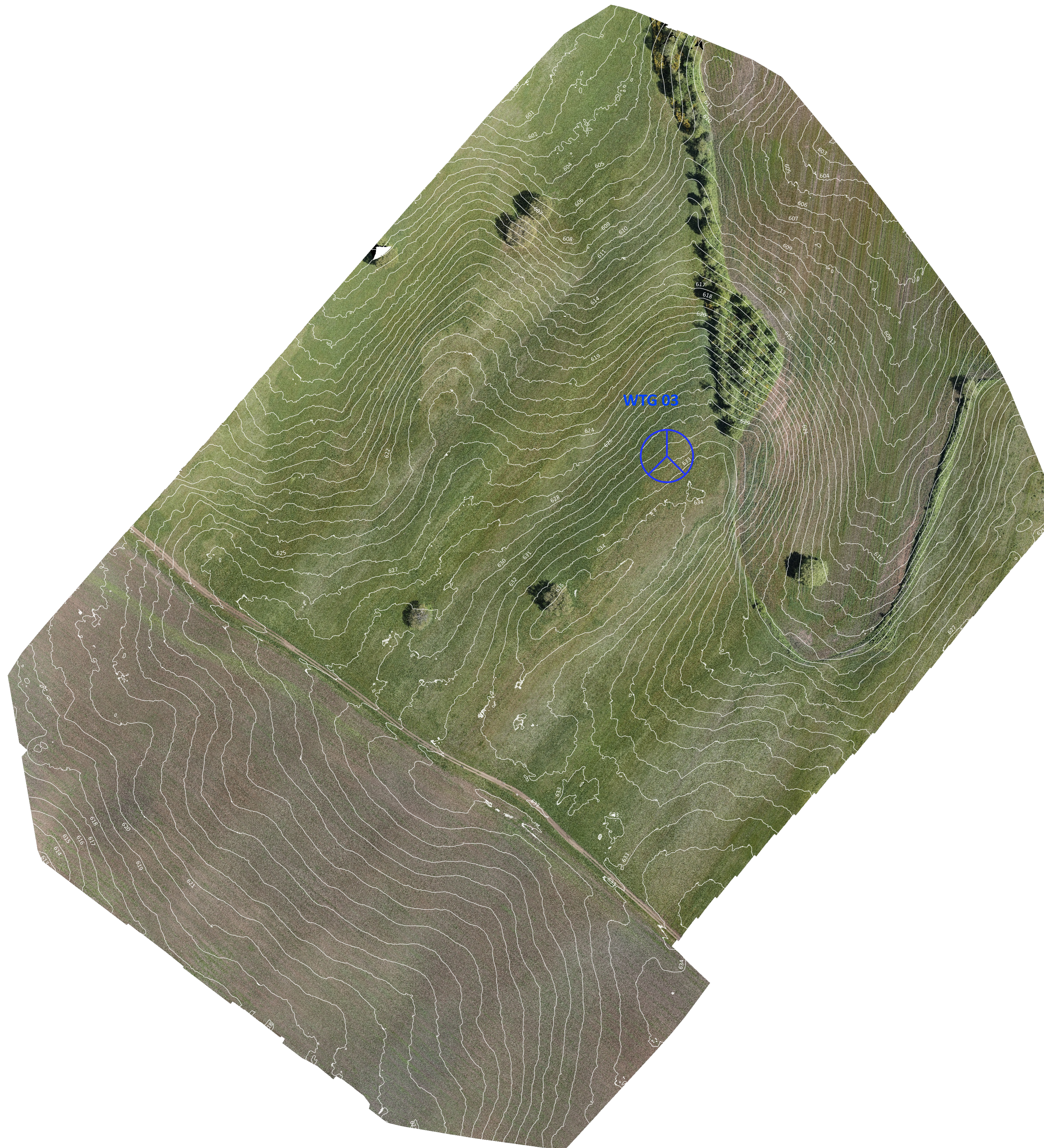
AREA WTG 3 ORTOFOTO DA RILIEVO DRONE CON CURVE DI LIVELLO risoluzione foto 3 cm/pixel - risoluzione DTM 25 cm/pixel
