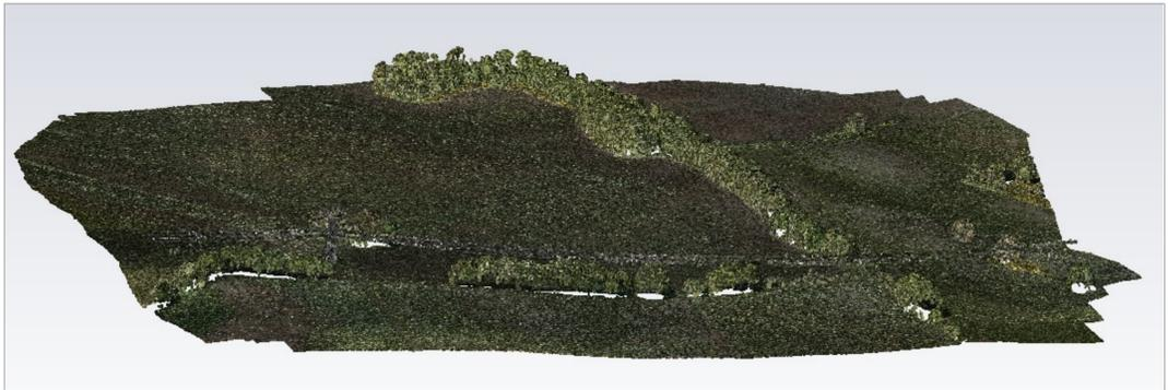
NUVOLO DI PUNTI DA RILIEVO DRONE
