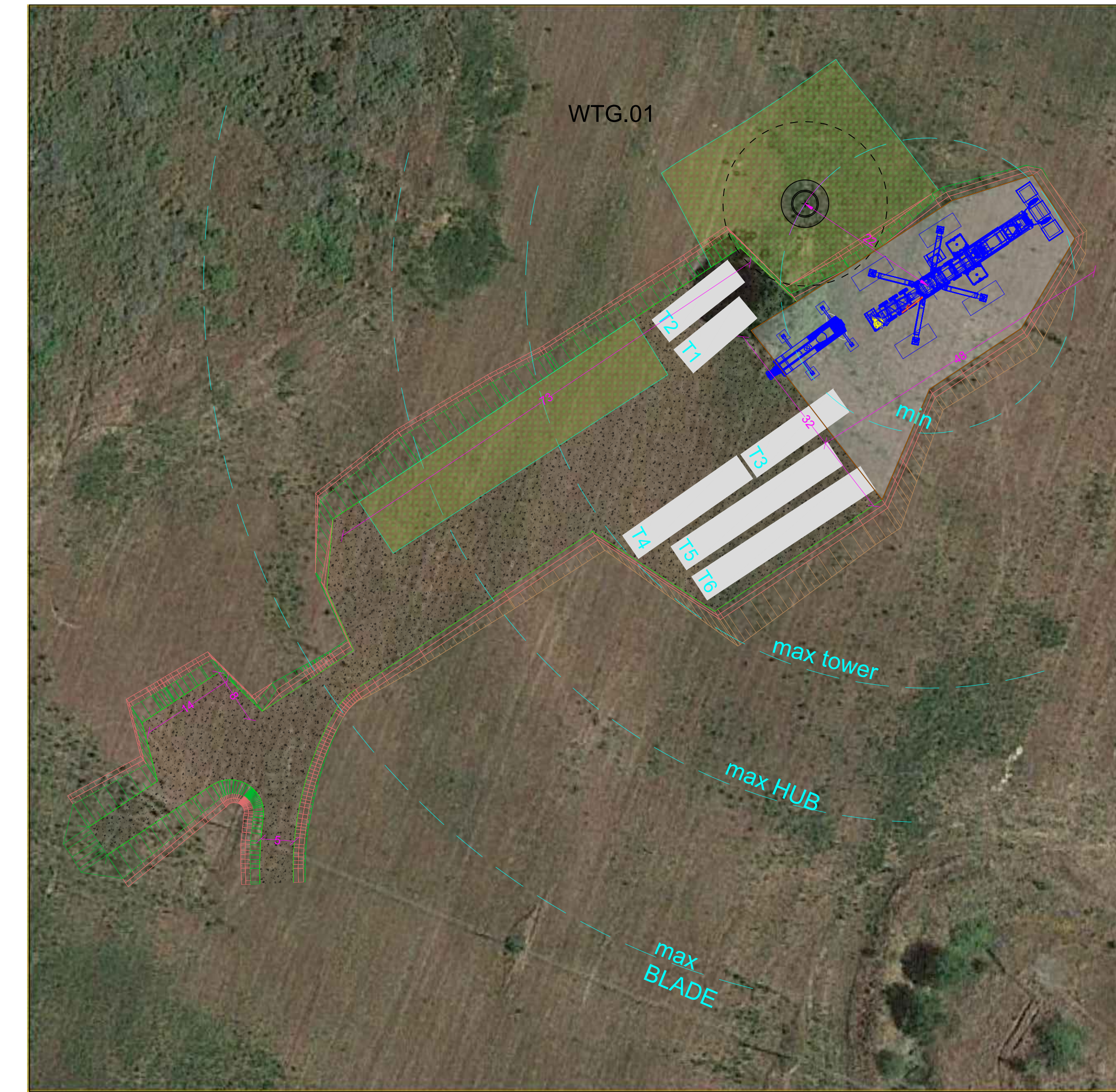
CONFIGURAZIONE 3 - MONTAGGIO TRAMI - SCALA 1:500
