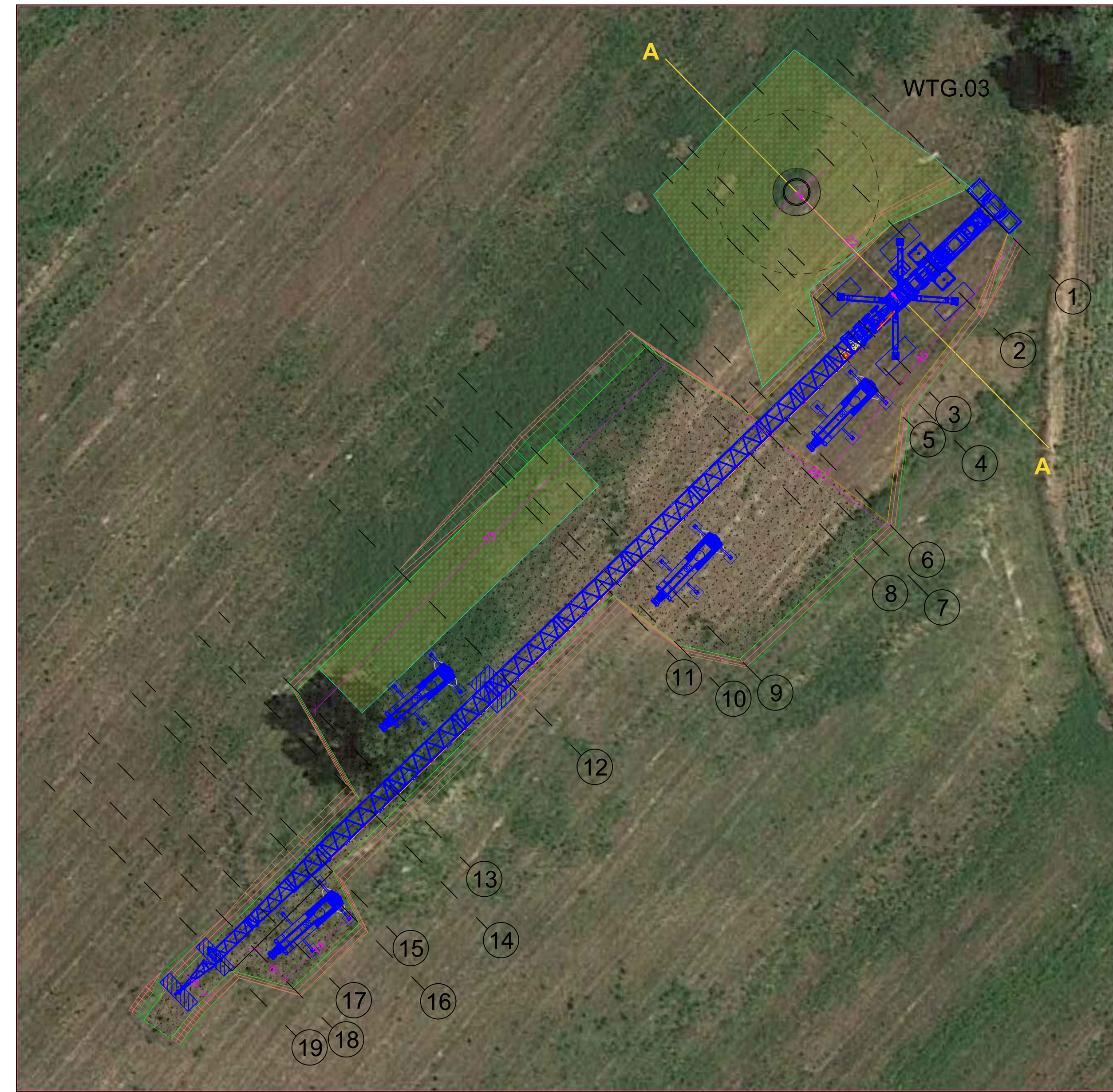
CONFIGURAZIONE 2 - MONTAGGIO GRU TRALICCIATA - SCALA 1:500
