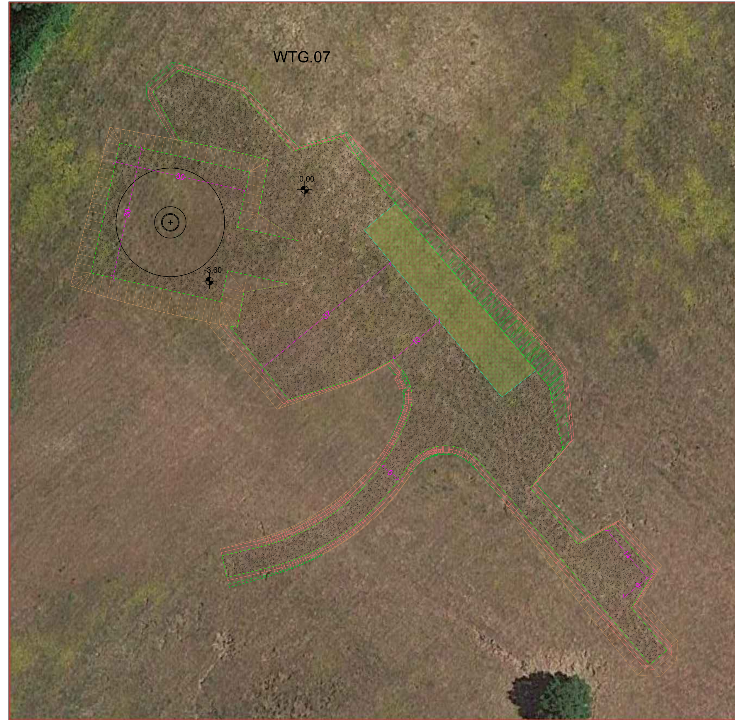
CONFIGURAZIONE 1 - SCAVO DI FONDAZIONE - SCALA 1:500
