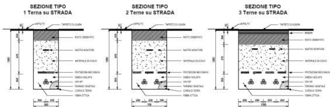
Sezioni tipiche di posa della linea in cavo su strada
