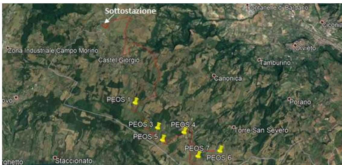
Ubicazione Stazione di rete e tracciato cavidotto
