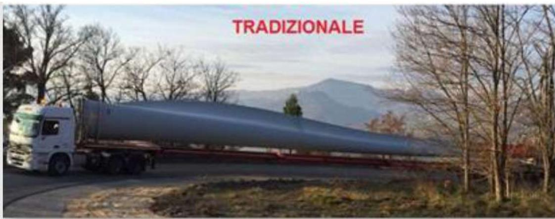
L'installazione degli aerogeneratori in progetto presuppone l'accesso, presso i siti di intervento, di mezzi speciali per il trasporto della componentistica delle macchine eoliche, nonché l'installazione di due autogru: una principale (indicativamente da 750 t di capacità max a 18-24 m di raggio di lavoro, braccio da circa 140 m) ed una ausiliaria (indicativamente da 250 t), necessarie per il montaggio delle torri, delle navicelle e dei rotori.
