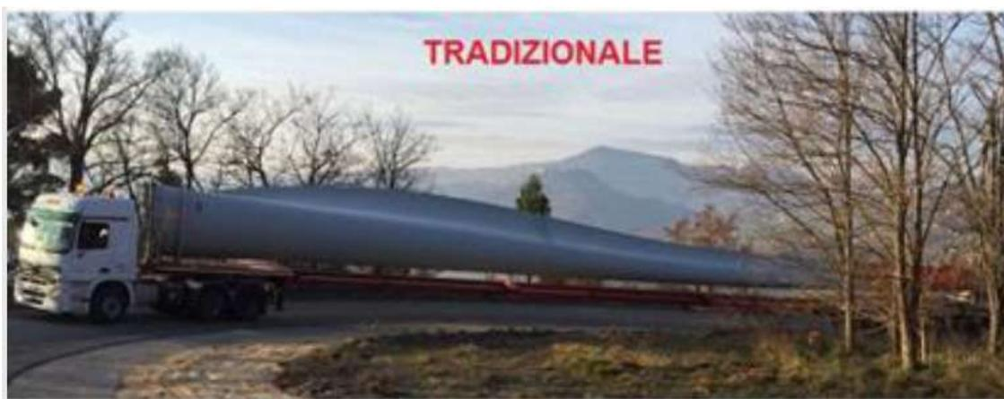
L'installazione degli aerogeneratori in progetto presuppone l'accesso, presso i siti di intervento, di mezzi speciali per il trasporto della componentistica delle macchine eoliche, nonché l'installazione di due autogru: una principale (indicativamente da 750 t di capacità max a 18-24 m di raggio di lavoro, braccio da circa 140 m) ed una ausiliaria (indicativamente da 250 t), necessarie per il montaggio delle torri, delle navicelle e dei rotori.
