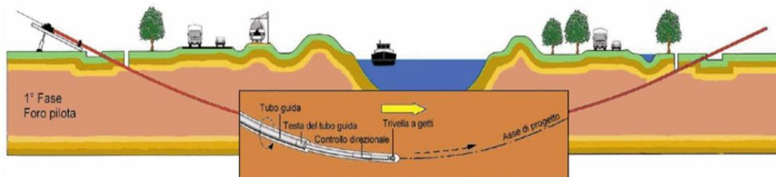
Figura 12 – Schema della fase di realizzazione del foro pilota (Pilot bore hole).
