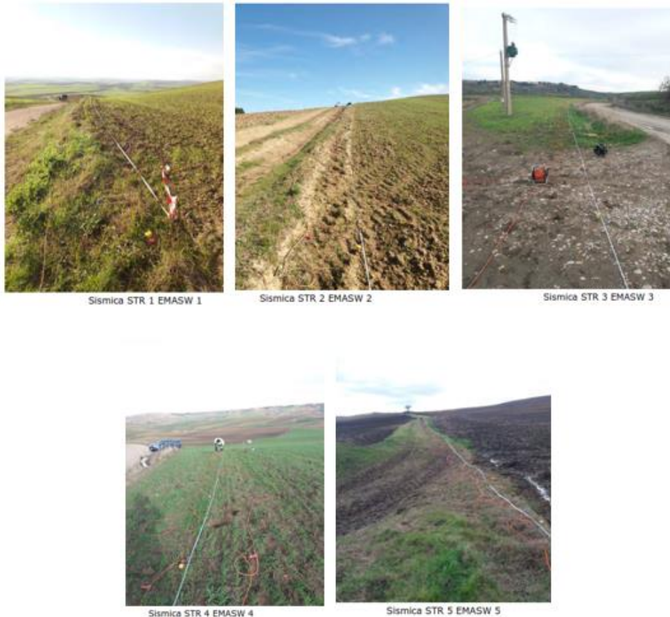
Figura 8: Report fotografico delle fasi di esecuzione delle indagini sismiche.
