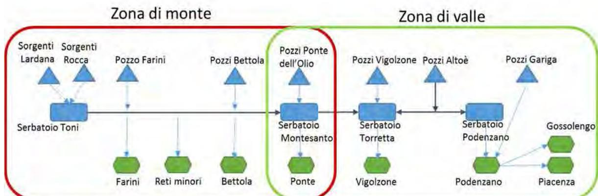
Figura 2.2 - Schema generale funzionamento rete acquedottistica Val Nure
