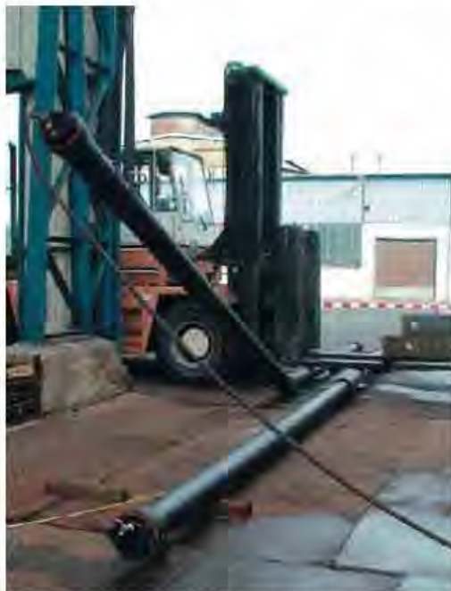
Figura 7: connessione BLS con bullone Pressione interna dell'acqua: 20 bar, deflessione angolare: circa 20°, connessione stretta
