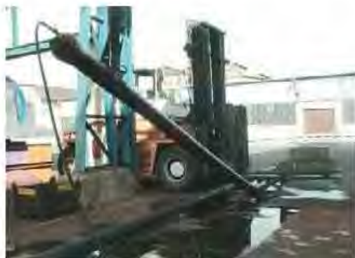
Figura 8: collegamento BLS con anello di serraggio Pressione interna dell'acqua: 20 bar, deviazione angolare circa 20°, collegamento a tenuta
