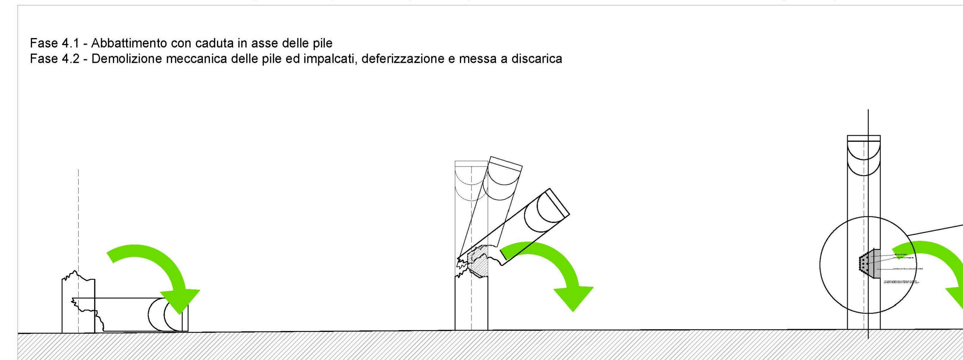
FASE 4.1 - Abbattimento da pila 18 a pila 37, tipo "A" per abbattimento con caduta in asse(1:200)
