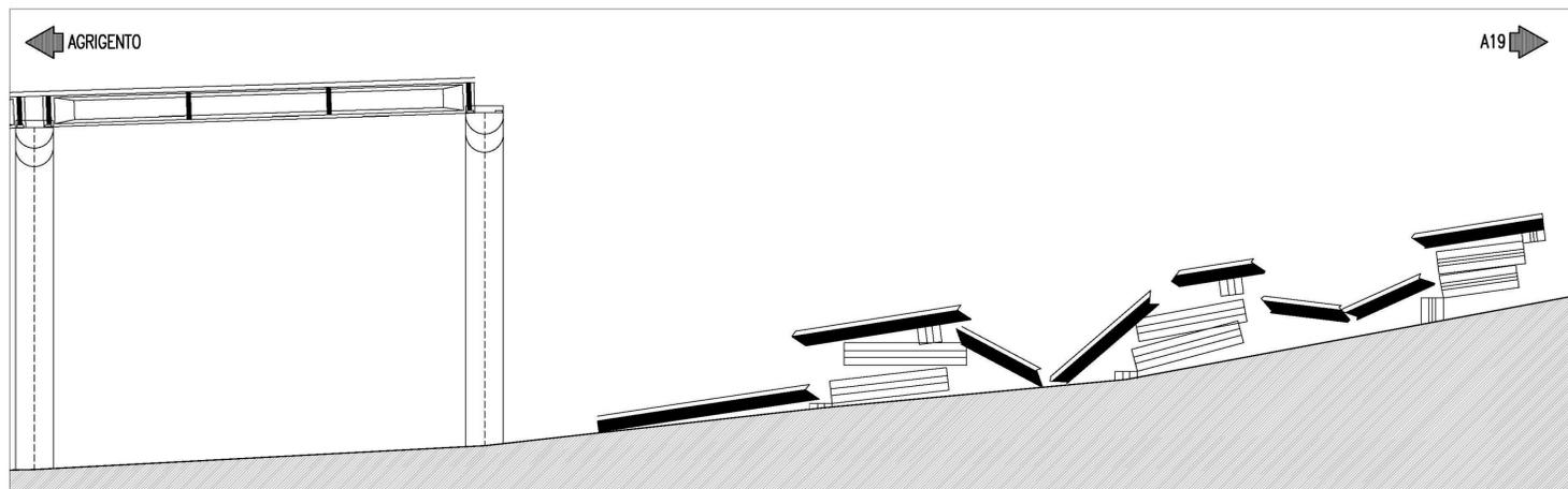
FASE 4 - DEMOLIZIONE MECCANICA, DEFERIZZAZIONE E MESSA A DISCARICA DELLE PILE E DELL'IMPLACATO A SEGUITO DETONAZIONE
