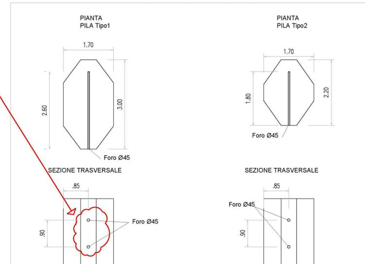
FASE 3 - DEMOLIZIONE DELLE PILE A SEGUITO DETONAZIONE E CADUTA IMPALCATO IN ASSE
