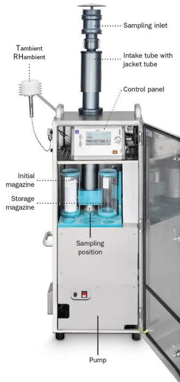
Figura 3 - Campionatore sequenziale automatico.
