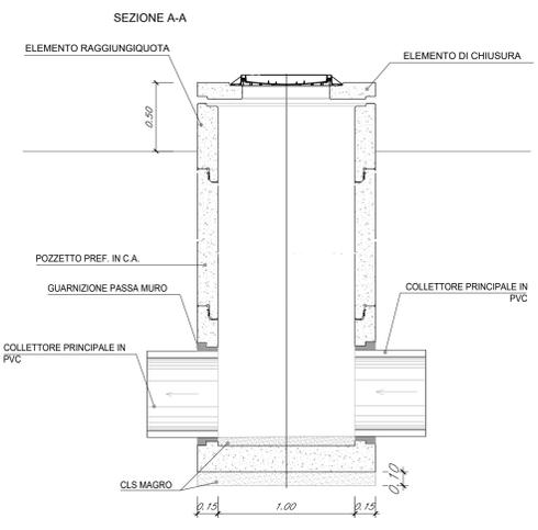
PARTICOLARE ELEMENTO DI CHIUSURA POZZETTO DI ISPEZIONE
