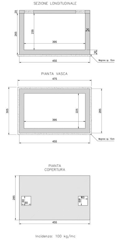
POZZETTI D'ISPEZIONE COLLETTORE PER ACQUE BIANCHE CON FUNZIONAMENTO A GRAVITA'
