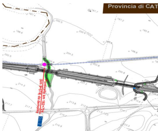
Stralcio planimetrico - Stato di progetto – demolizione DL02
