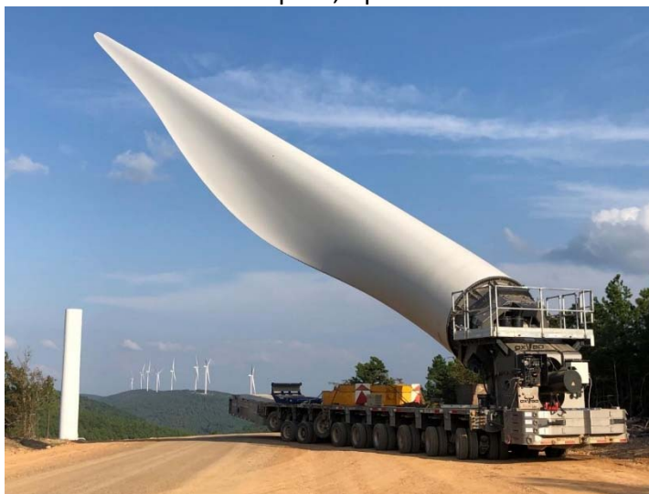
Figura 1: Trasporto mediante Blade Lifter
