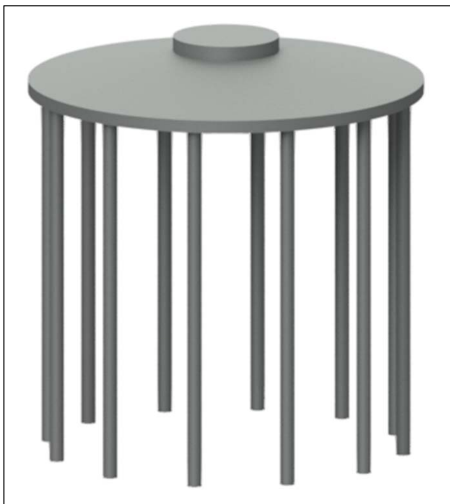
Figura 1: vista tridimensionale della fondazione dell'aerogeneratore
