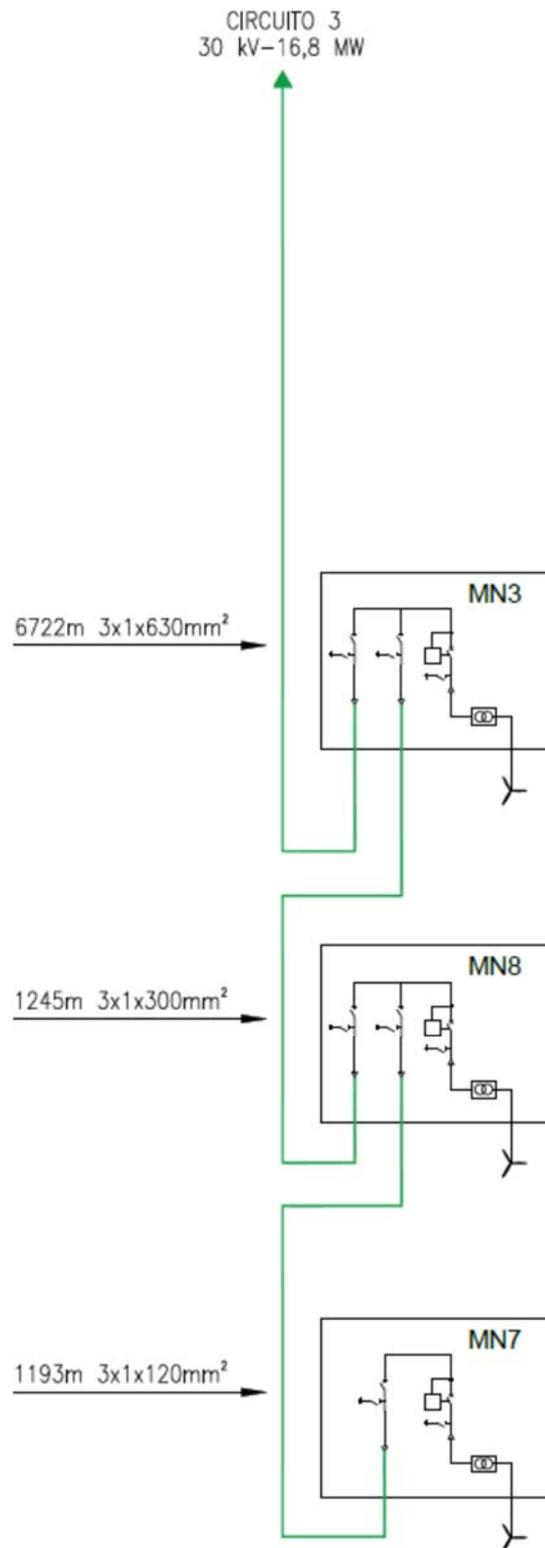
Figura 2: schema a blocchi parco eolico (circuito 3)
