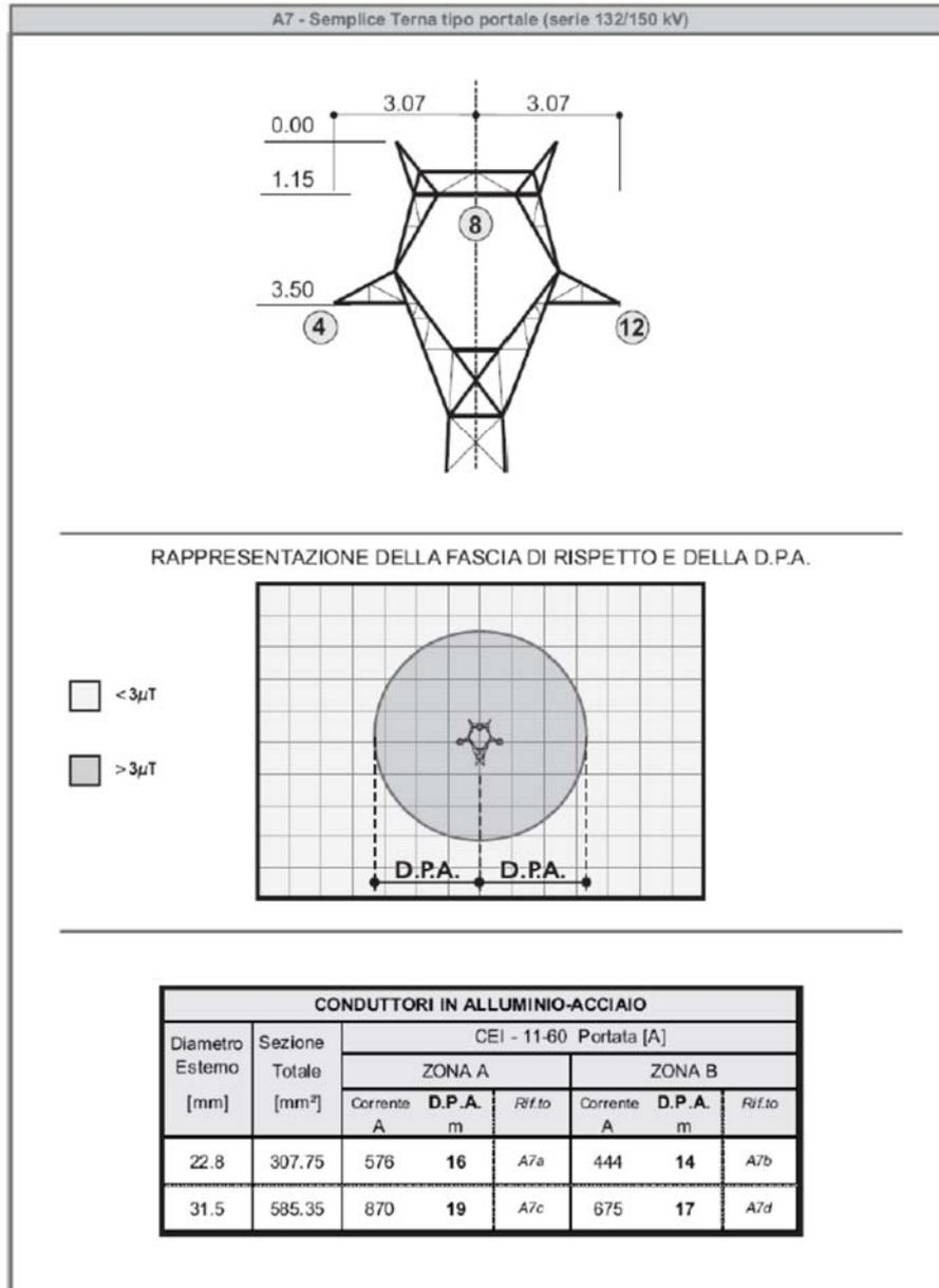
Figura 3: Scheda A7 ("Linea guida per l'applicazione del § 5.1.3 dell'allegato al dm 29.05.08")
