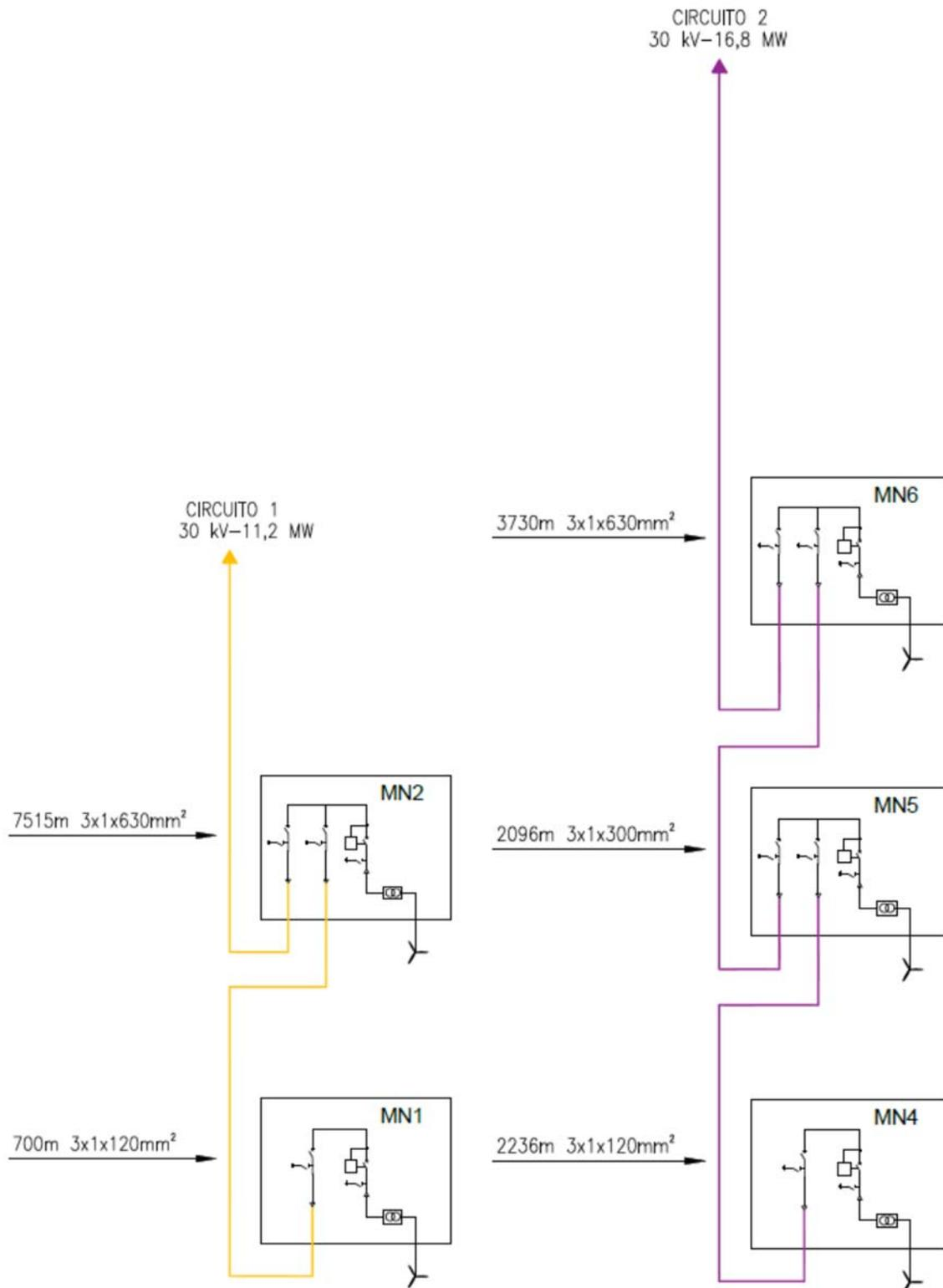
Figura 1: schema a blocchi parco eolico (circuiti 1 e 2)
