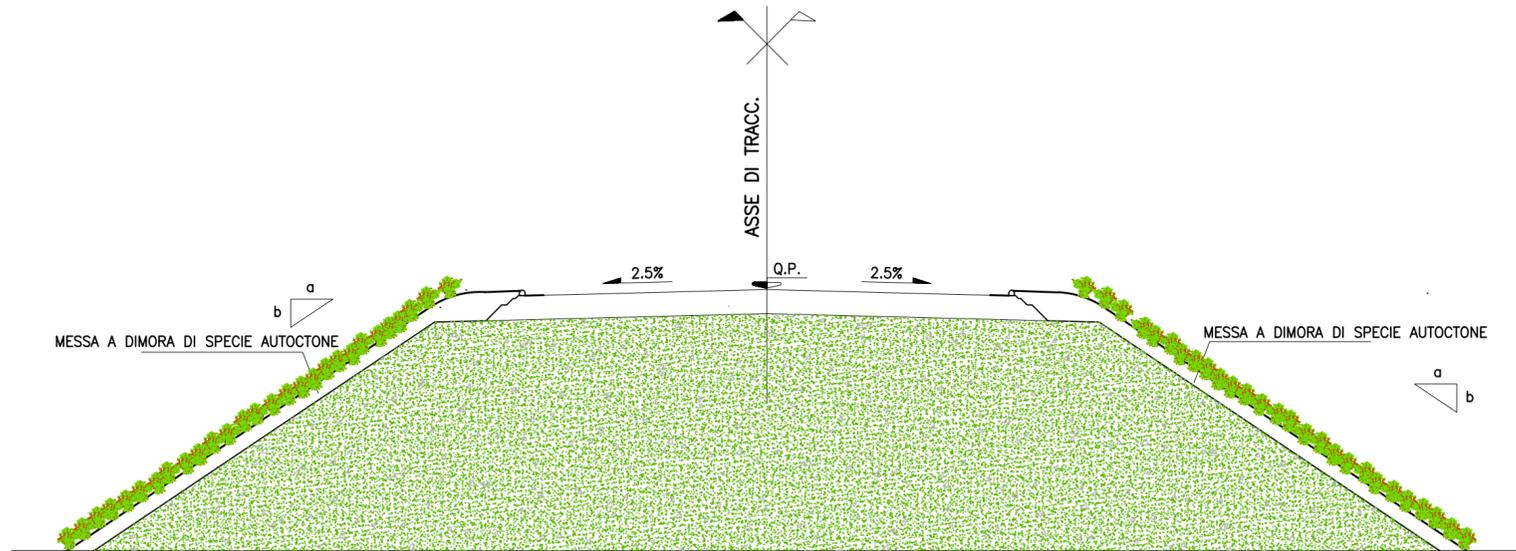
SISTEMAZIONE A VERDE SEZIONE TIPO IN SCAVO
