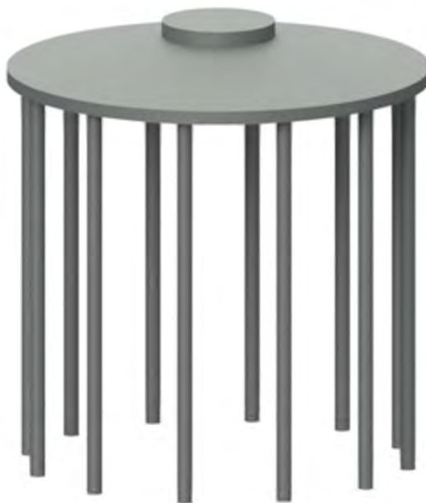
Figura 11: vista tridimensionale della fondazione dell'aerogeneratore
