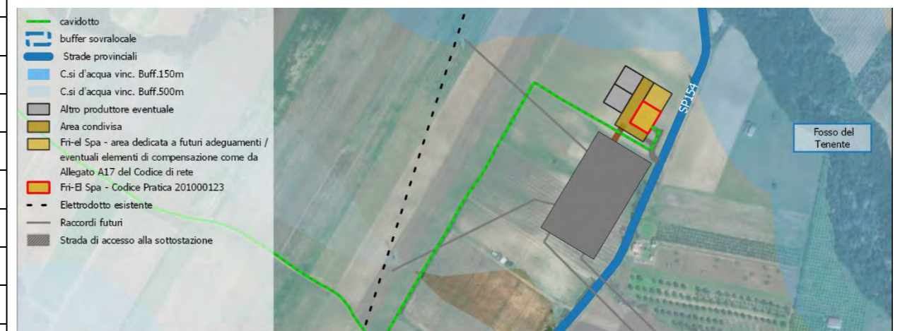
Figura 3: Sovrapposizione di parti del cavidotto e della sottostazione con il buffer dei corsi d'acqua vincolati
