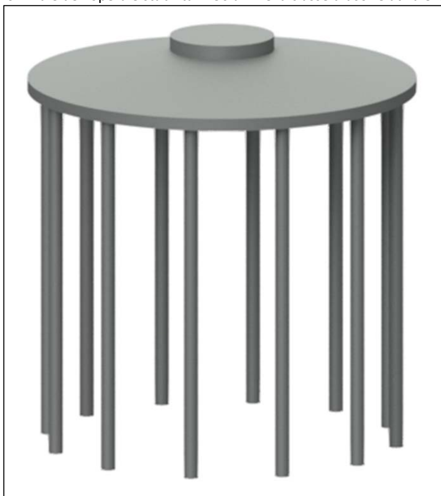
Figura 7: vista tridimensionale della fondazione dell'aerogeneratore
