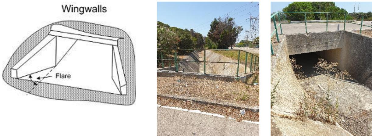
Figura 18: Modello con muri d'ala raccordati, attraversamento P1 e attraversamento P2
