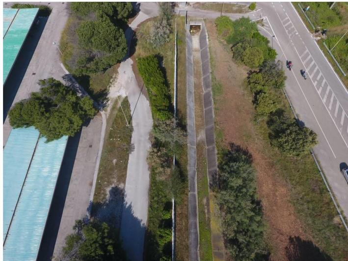
**Figura 9: Canale della Giumenta dopo la ripulitura e la tombinatura P2 (foto 2021)**
