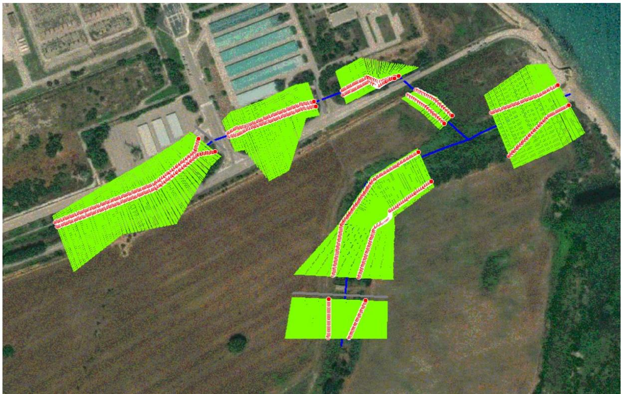
**Figura 17: Vista planimetrica delle sezioni, comprese quelle interpolate, utilizzate nel modello idraulico**
