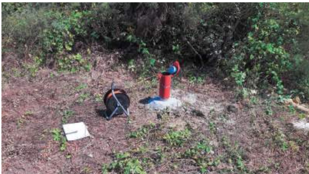
Misurazione del livello statico falda da S1-Pz1
