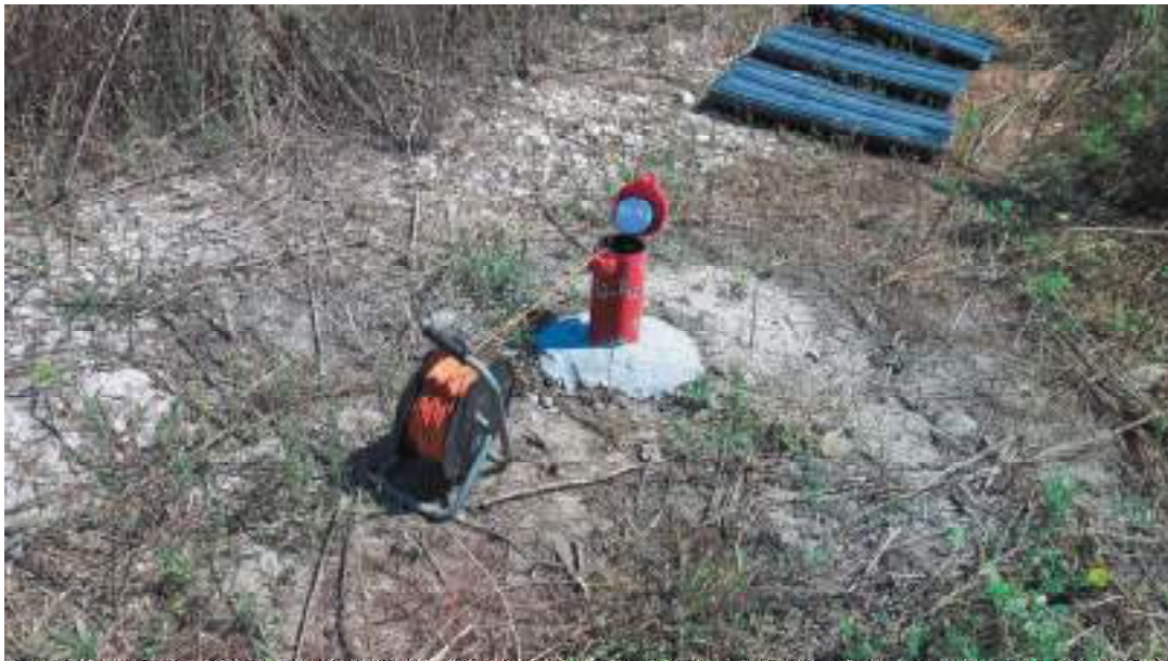
Misurazione del livello statico falda da S2-Pz2
