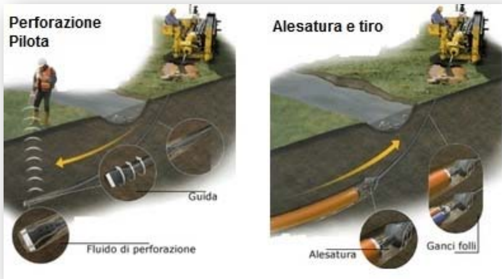
Figura 60 - tecnologia di trivellazione orizzontale controllata (TOC)
