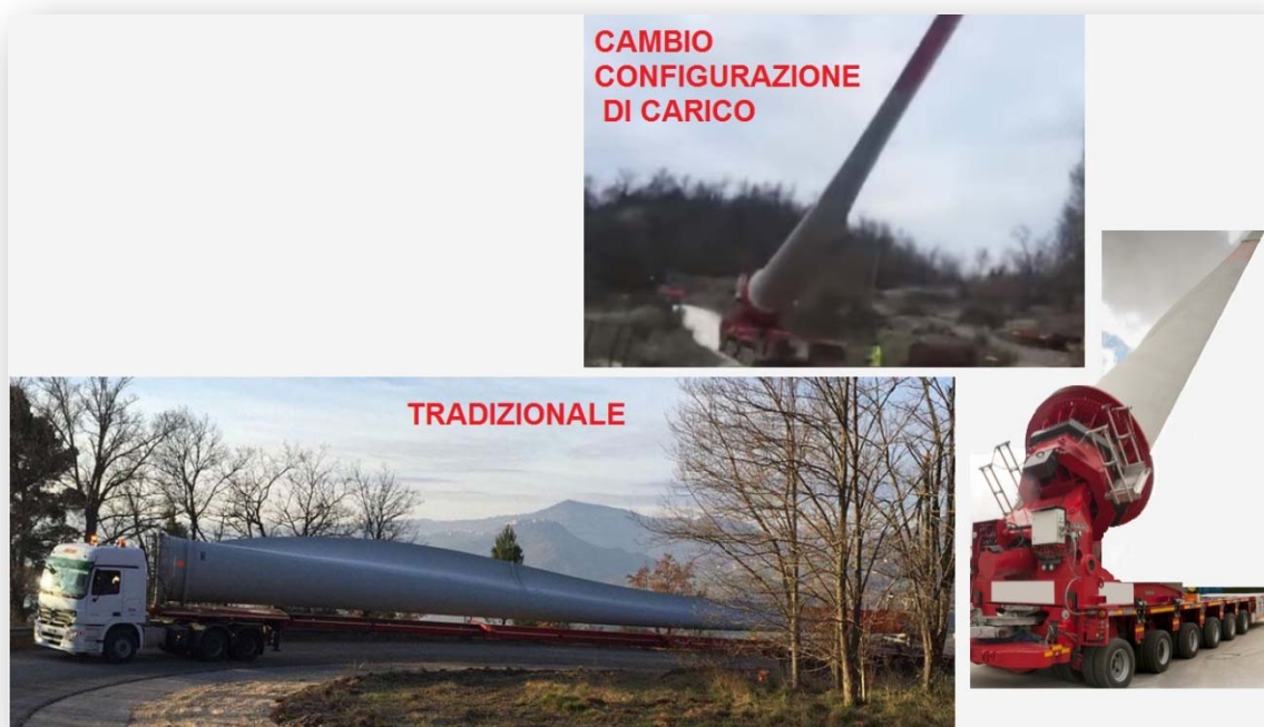
Figura 47 – esempi di trasporto tradizionale e soluzione con cambio della configurazione di carico durante il percorso
