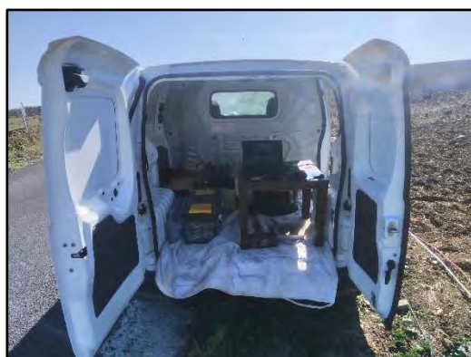
Fotografia 27 -Sismografo PASI modello GEA24
