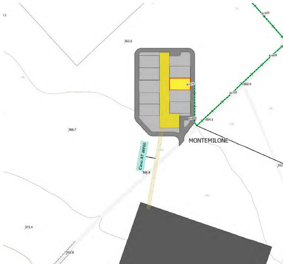
Figure 2: Ubicazione planimetrica della stazione utente rispetto alla stazione RTN
