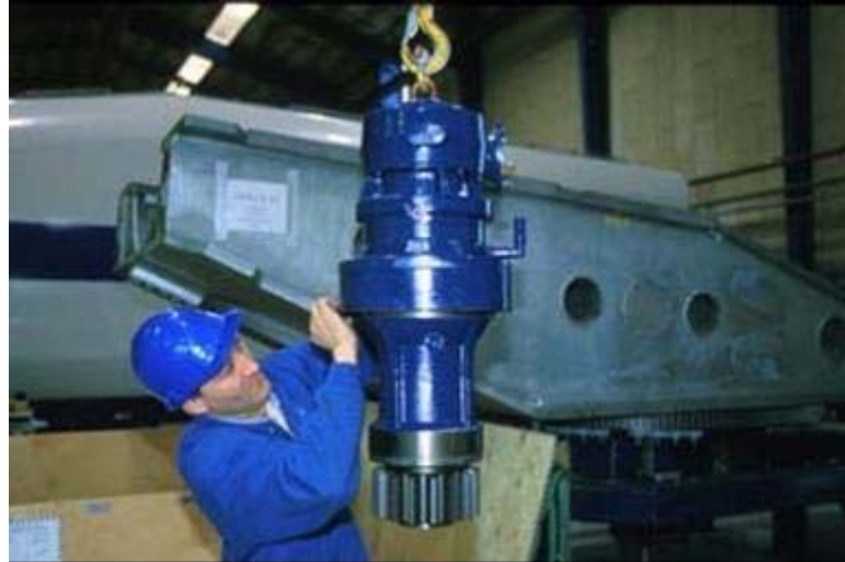
Figura 6: motori di giro e riduttori
