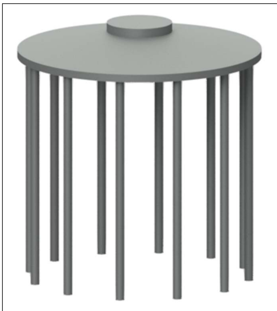
Figura 1: vista tridimensionale della fondazione dell'aerogeneratore
