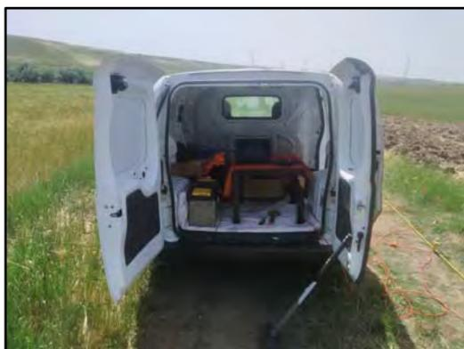
**Fotografia 19**-Sismografo PASI modello GEA24
