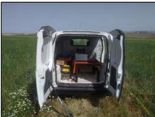
**Fotografia 15**-Sismografo PASI modello GEA24
