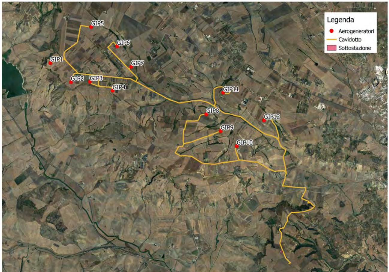
Figura 3. Layout di impianto su base ortofoto
