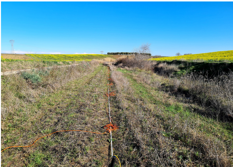
Prospezione Sismica a Rifrazione 2
