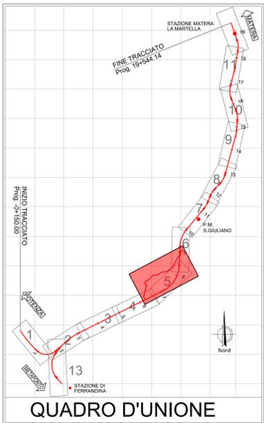
N.B. : il progetto è stato redatto su rilievo celerimetrico; cartografia di riferimento in scala 1:5000
