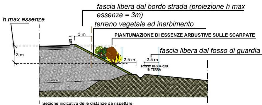
E' prevista la messa a dimora di fasce arbustive su rilevati e trincee allo scopo di prevenire i fenomeni erosivi e contemporaneamente costituire mitigazione paesaggistica di riconnessione con i margini dell'intervento. Le specie da utilizzare per l'intervento descritto sono le seguenti:
