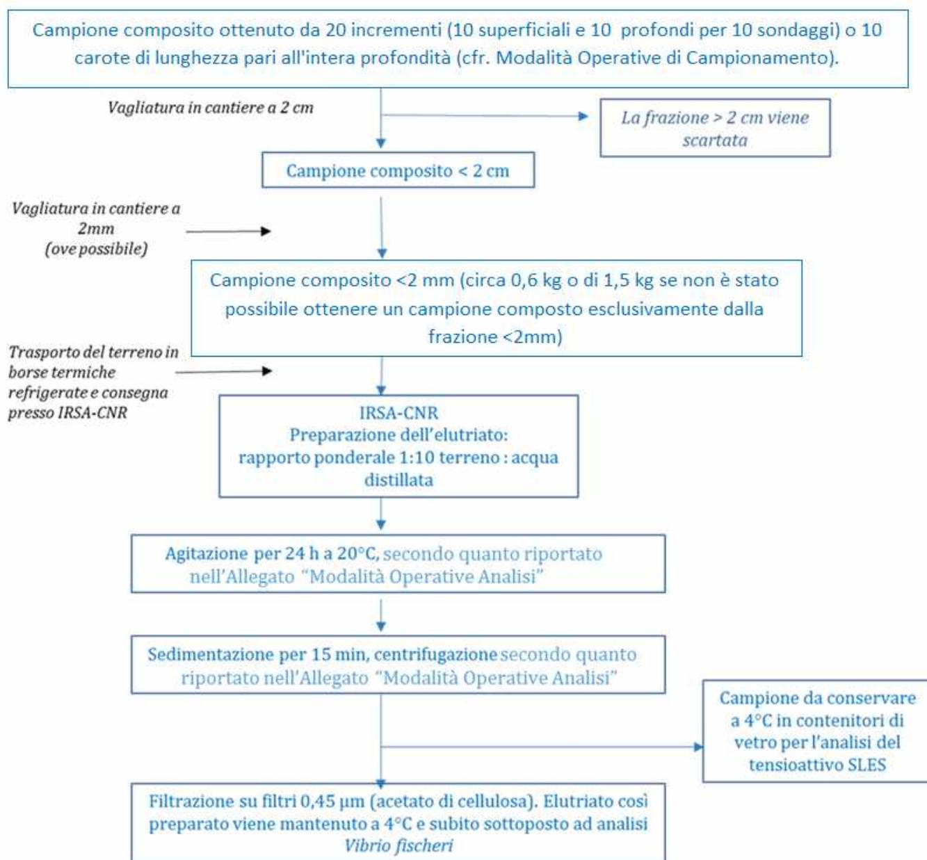
Figura 4 – Diagramma di campionamento, vagliatura e preparazione elutriato
