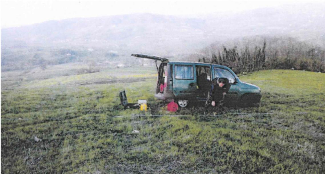
Figura 13: MASW nell'area di intervento, per la caratterizzazione sismica del sito
