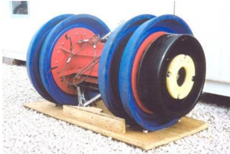
Figura 2-32 – Pig strumentale per il controllo della geometria e dello spessore della condotta
