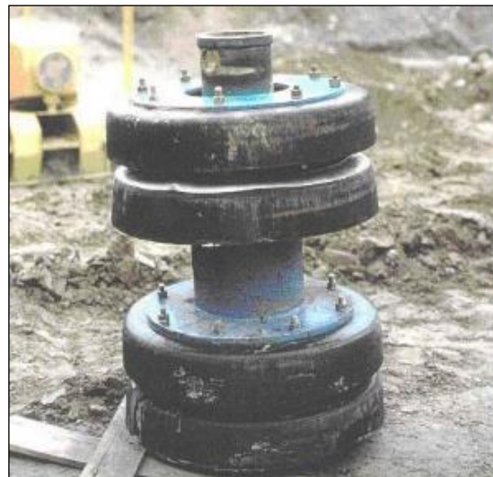
Figura 2-31 – Pig convenzionale impiegato in operazioni di collaudo idraulico e pulizia della condotta
