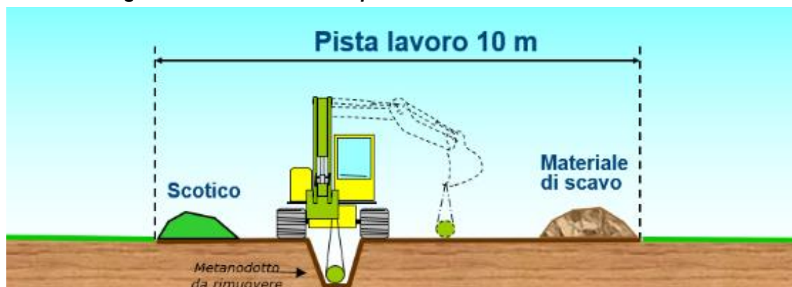
Figura 2-28 – Pista di lavoro per rimozione condotta esistente
