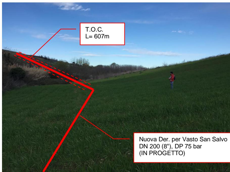
Foto n.16 – Km 4+845 - Metanodotto in progetto con vista T.O.C.
