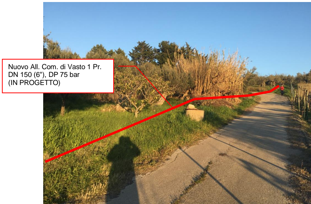
Foto n.8 – Km 3+940 - Nuovo All. Com. di Vasto 1 Pr. Dn 150 (6") DP 75 bar (IN PROGETTO)
