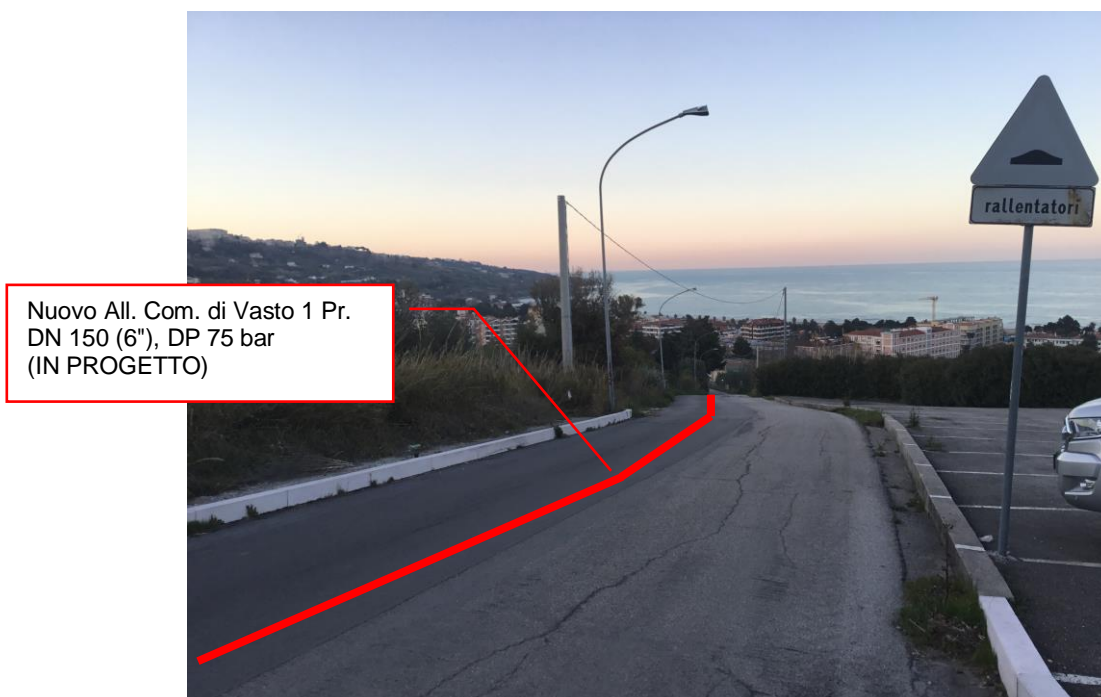
Foto n.10 – Km 4+500 - Metanodotto in progetto su strada asfaltata Via Montevecchio
