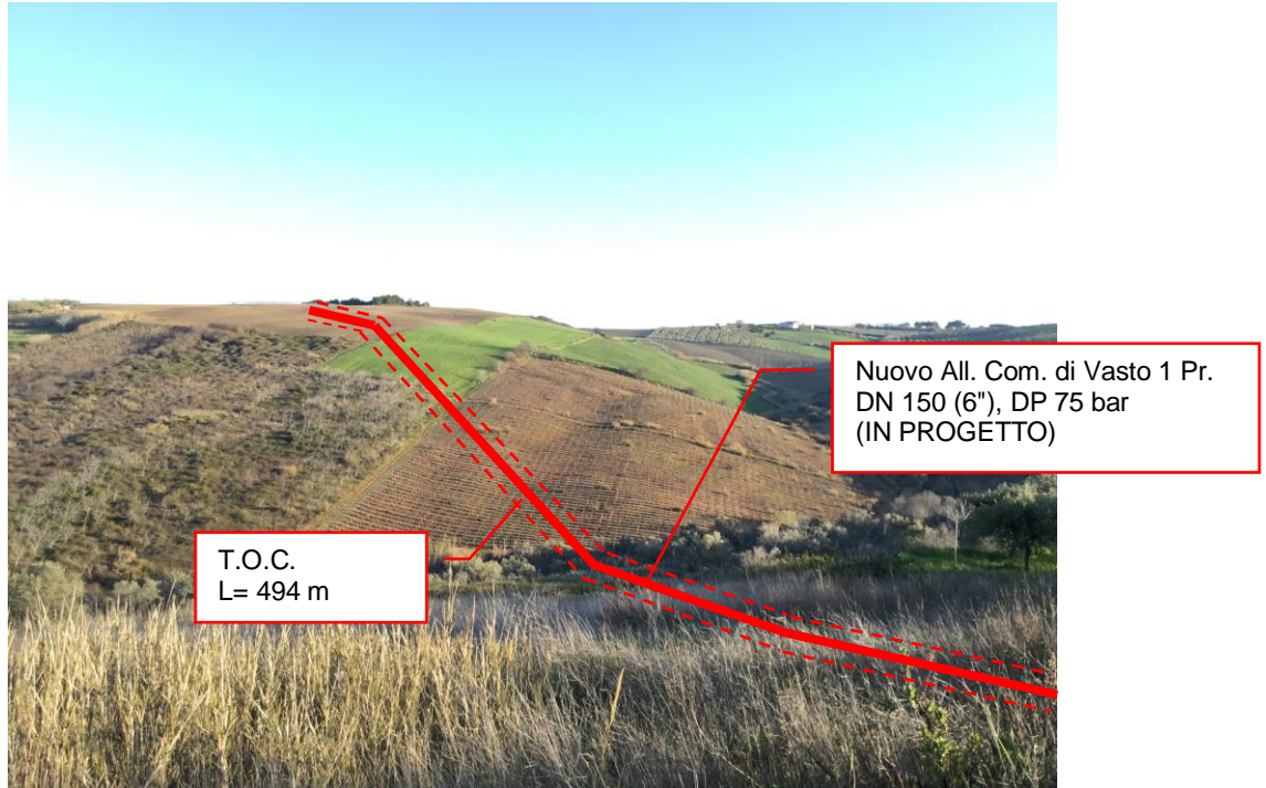
Foto n.7 – Km 3+210 - Nuovo All. Com. di Vasto 1 Pr. Dn 150 (6") DP 75 bar (IN PROGETTO) con vista TOC
