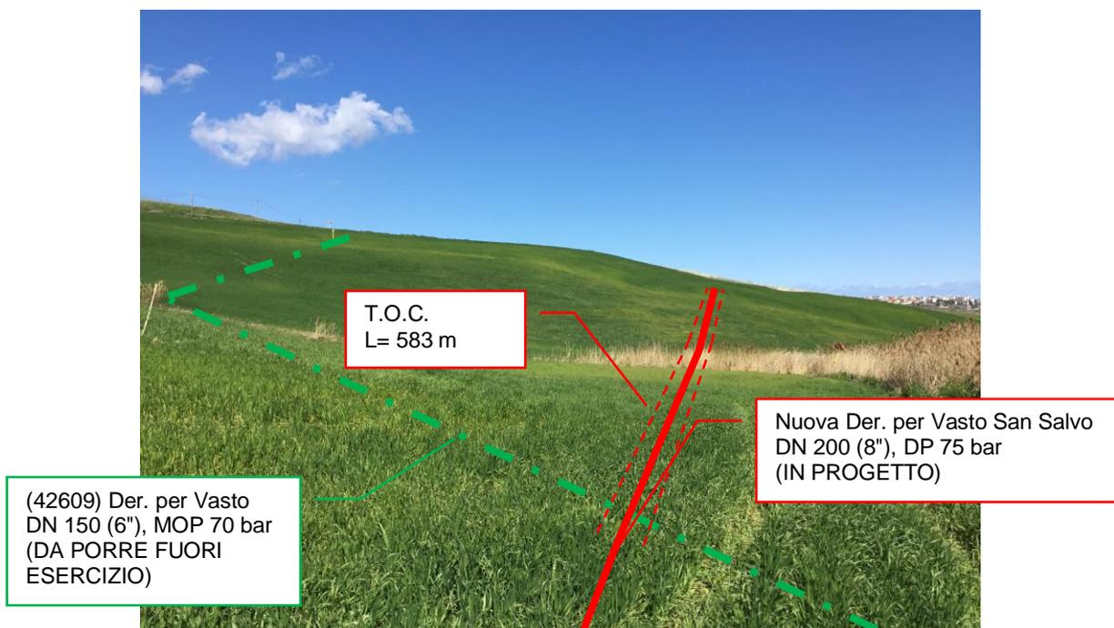
Foto n.7 – Km 0+860 - Metanodotto in progetto con vista T.O.C. e metanodotto da porre fuori esercizio
