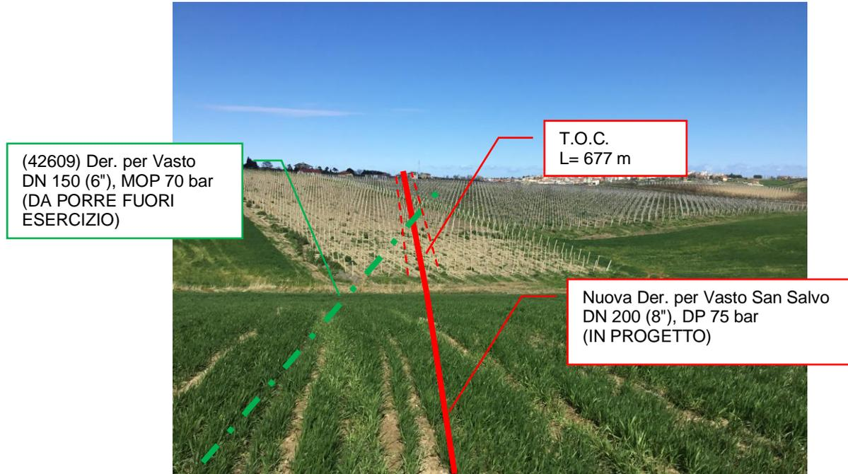
**Foto n.8 – Km 1+511 - Metanodotto in progetto con vista T.O.C. e metanodotto da porre fuori esercizio**
