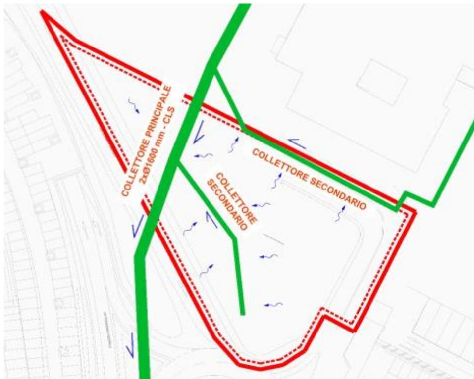
Figura 2-6 Schema planimetrico del sistema di raccolta delle acque dell'area di cantiere logistico
