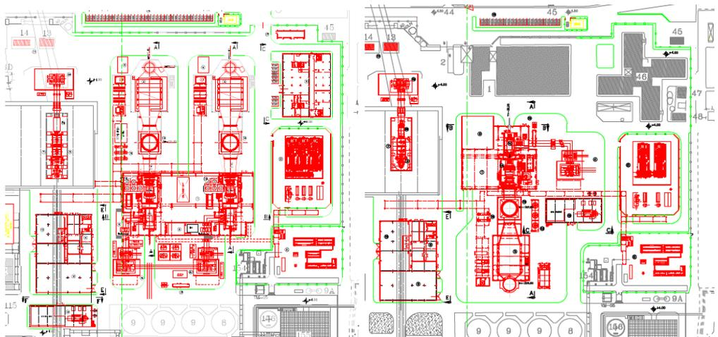
*Confronto in planimetria della configurazione 2+1 con la nuova configurazione alternativa 1+1*
