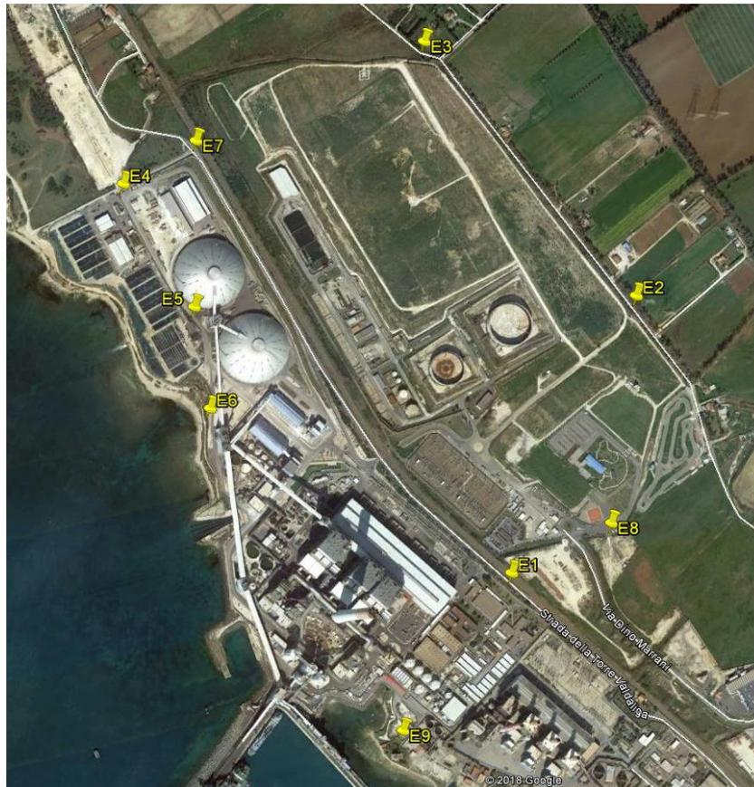
Figura 5.3.2 – C.le di Torrevaldaliga Nord: ubicazione dei punti di misura del rumore ambientale E1÷E9
