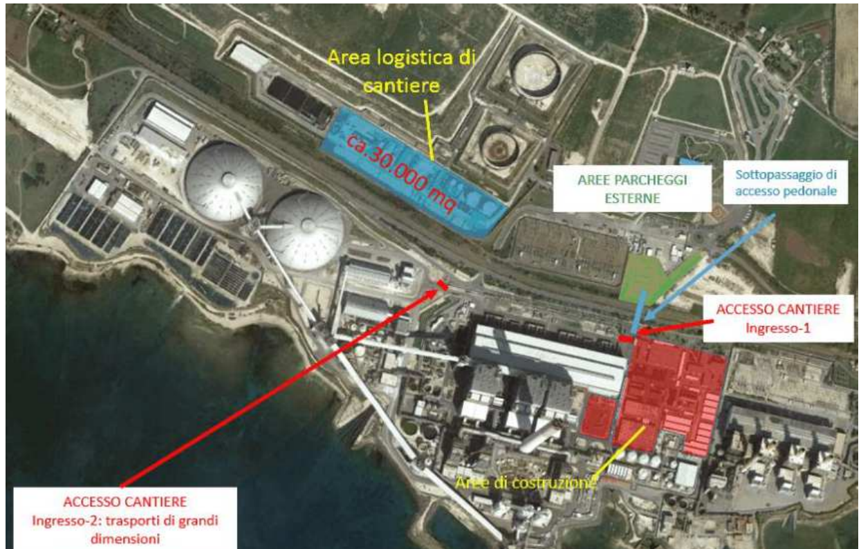
Figura 2.2.2 – Rappresentazione delle aree di cantiere previste
