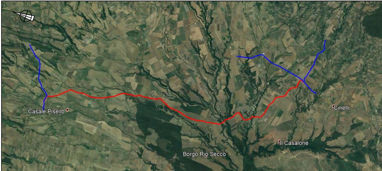
**Figura 2** – Stralcio immagine satellitare con localizzazione del tracciato (in rosso linea in progetto e in blu metanodotto in esercizio)
