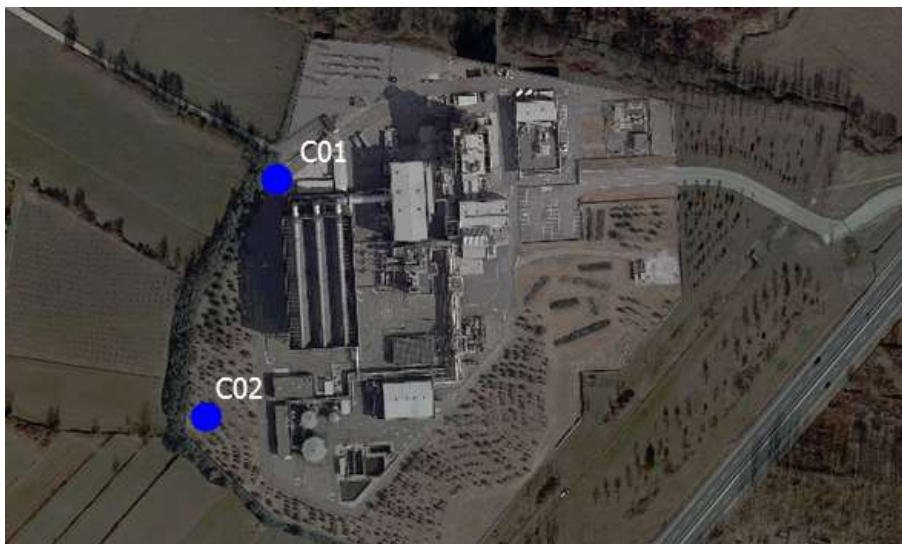
Figura 2-4 Indagini fonometriche per la verifica del clima acustico in corrispondenza della Centrale (misure Cxx)
